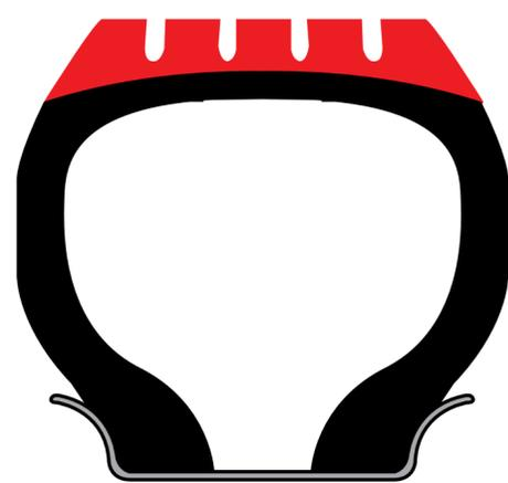
**Recauchutagem:** é o processo em que a banda de rodagem é substituída junto com os ombros do pneu. A recauchutagem é realizada no processo "a quente".
